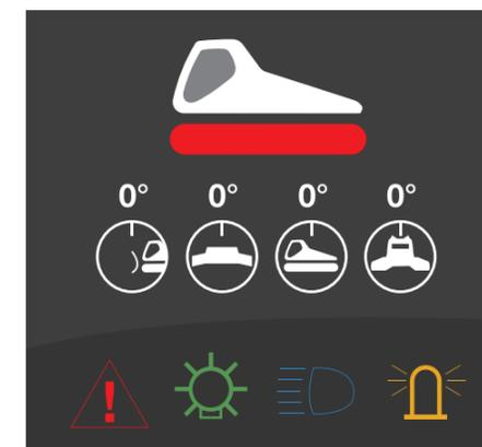
Funktionsrückmeldung sowie Fehlerdiagnose im Hauptscreen, Detailanalyse in der Menüebene Service
