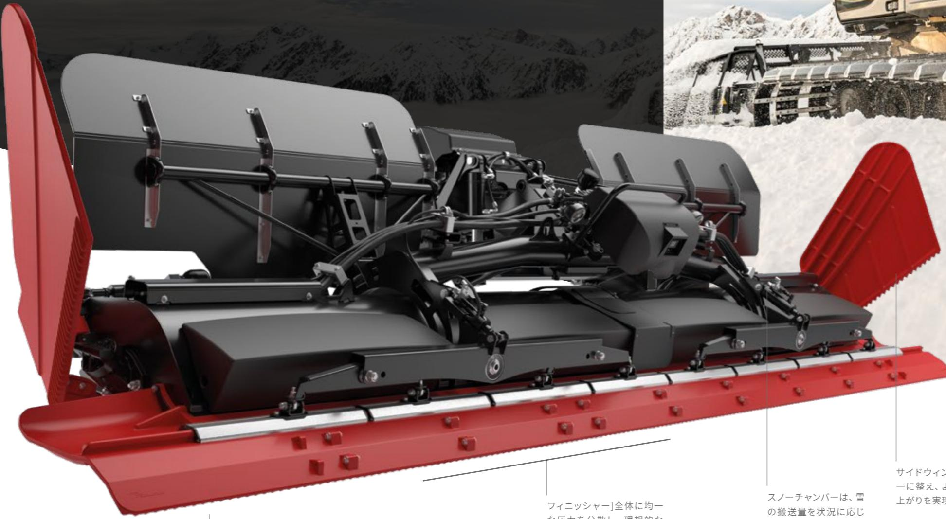
ティラーの爪は最適な仕上がりを生み出すよう配置され、独自の形状により正転・逆転どちらの回転方向でも高精度な整地を可能にします。
