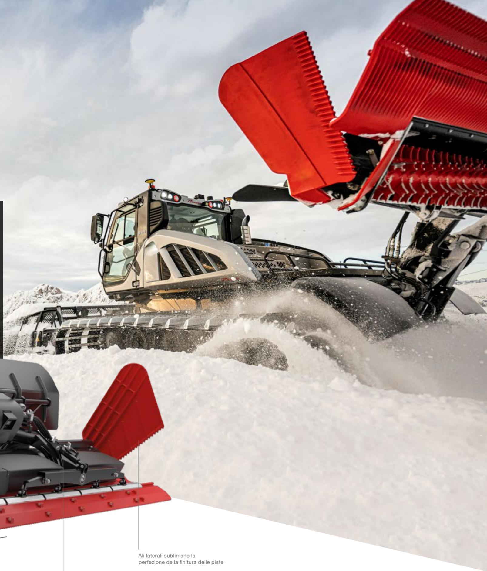
Disposizione dei denti di fresatura per risultato perfetto e forma del dente di fresatura permette la fresatura in entrambi i sensi di rotazione
