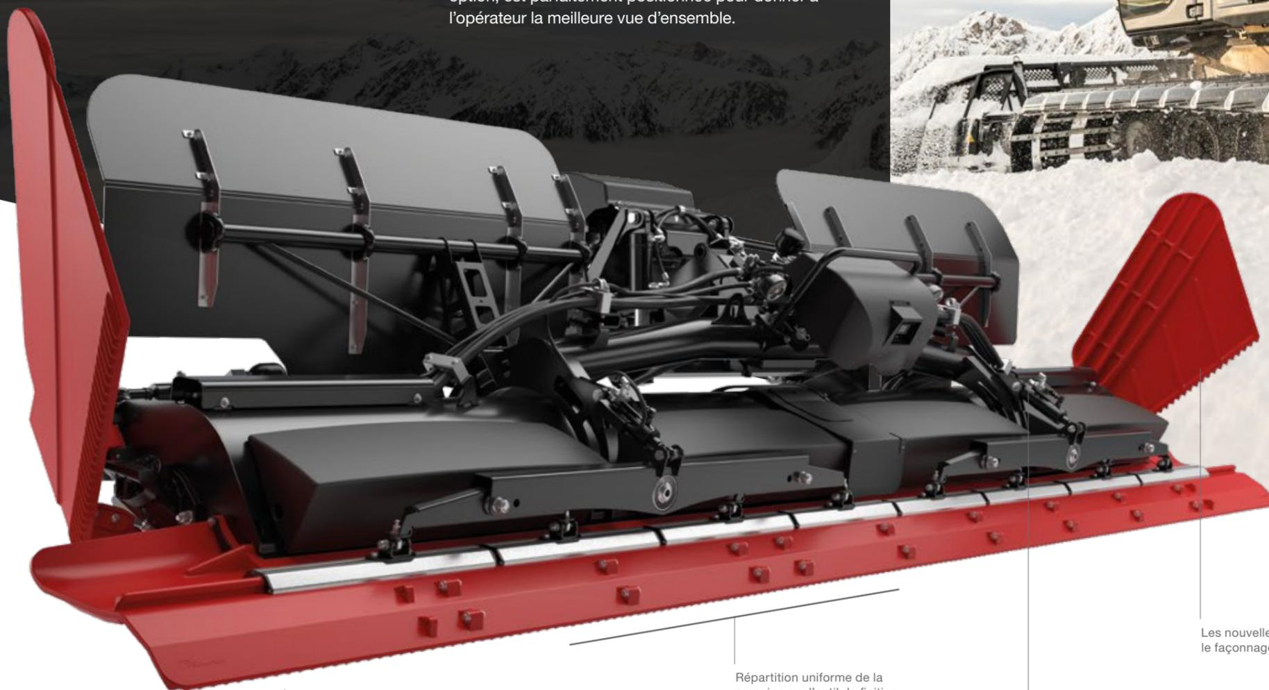
La disposition des dents de la fraise permet des résultats parfaits et la forme des dents de la fraise permet le fraisage dans les deux sens de rotation
