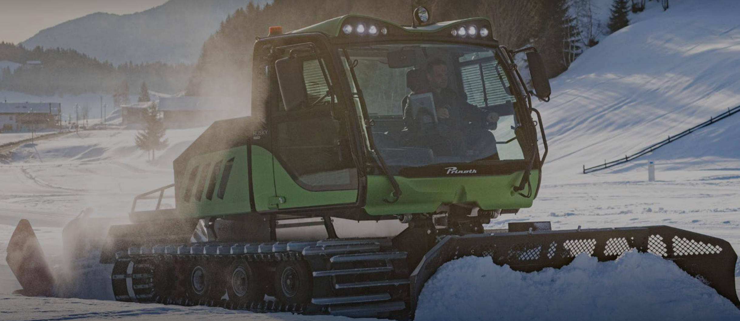
Il motore elettrico eroga 180 kW / 245 CV con 1.000 Nm di coppia fin dall'inizio. Questo significa prestazioni dal momento in cui il veicolo viene messo in moto. Solo un battipista elettrico può offrire questa quantità di coppia fin dall'inizio. Con un'autonomia di fino a 3 ore, la maggior parte delle piste da fondo e delle piccole piste possono essere preparate prima di dover ricaricare.
