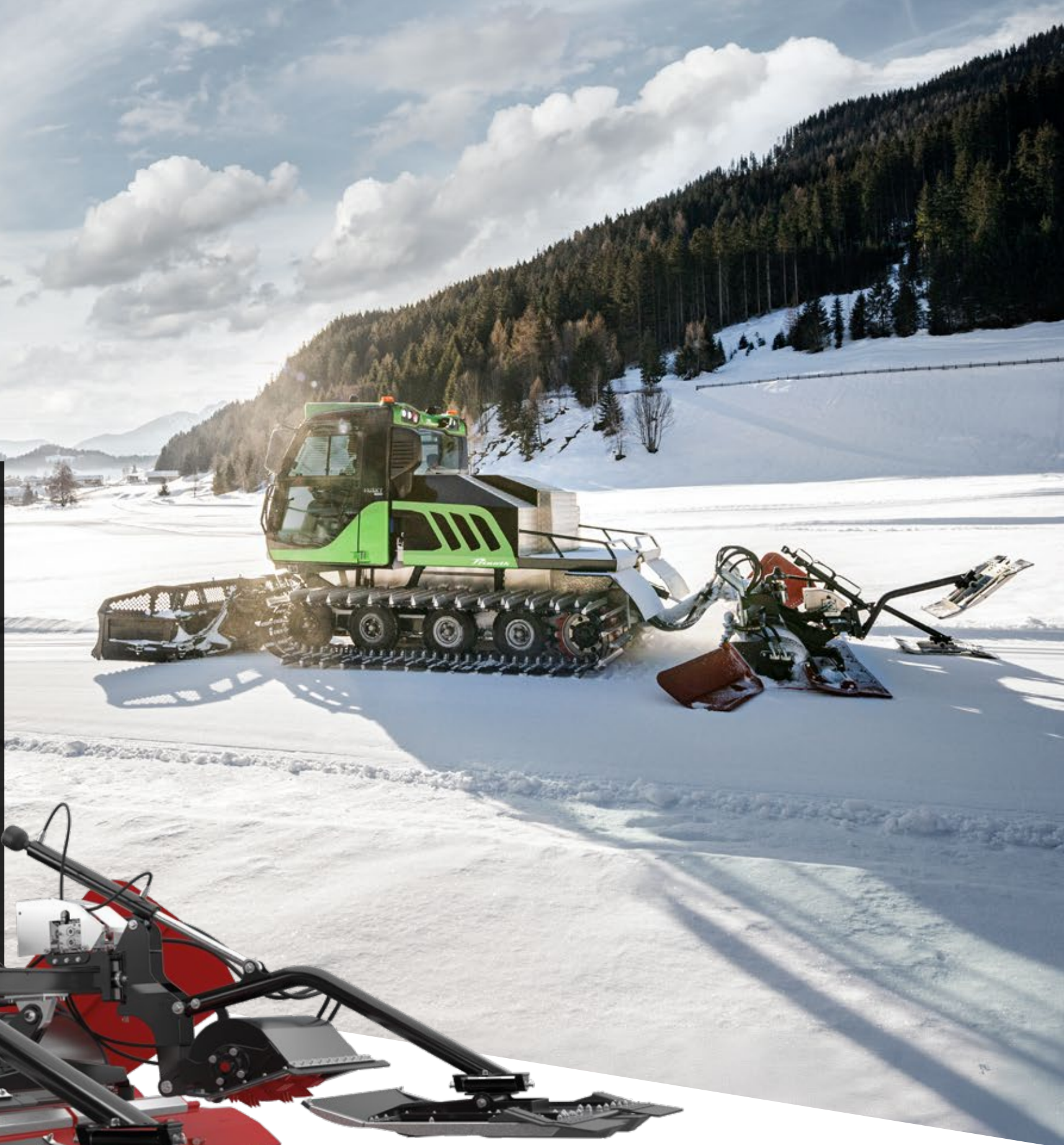
Deplacement lateral a systeme hydraulique du traceur
