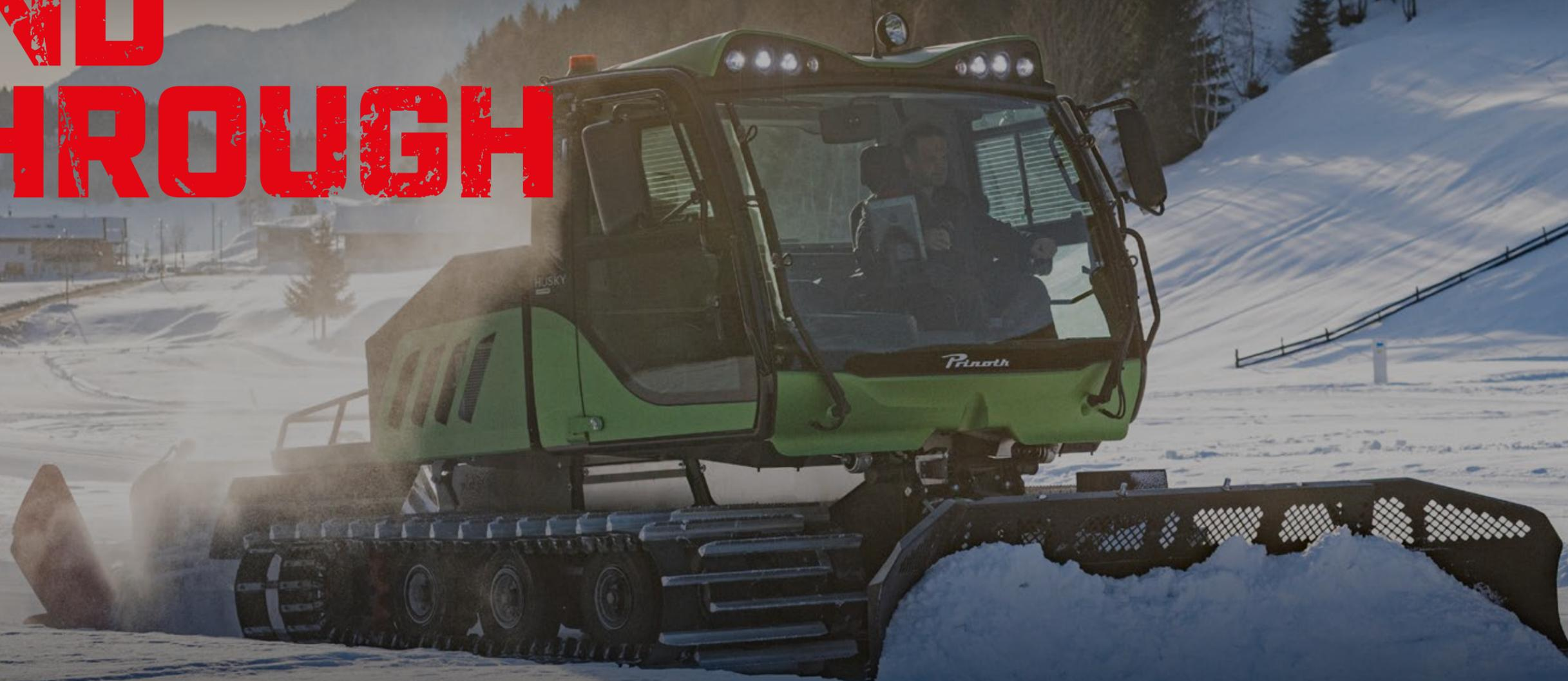
Le moteur électrique délivre une puissance de 180 kW / 245 ch avec un couple de 1 000 Nm dès le départ. Cela signifie des performances dès la seconde où le véhicule est mis en marche. Seule une dameuse électrique peut offrir un tel couple dès le départ. Avec une autonomie de 3 heures, la plupart des pistes de ski de fond et des petites pentes peuvent être préparées avant un rechargement.
